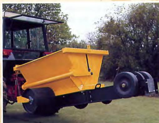
Das Auffüllen des HOPPERS ist sowohl stationär oder während der Fahrt durch einen nebenher fahrenden Anhänger oder andere gewünschte Beladeform möglich.
