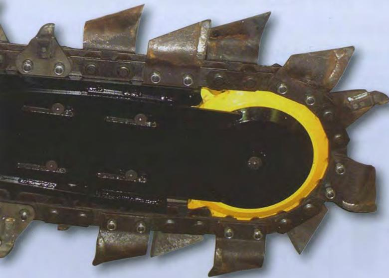
**Die Grabenbreiten sind leicht variierbar von 125 bis 400mm, mit Grabentiefen bis 1.6 m.**
