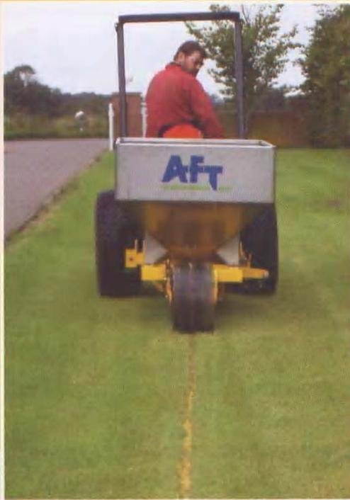
**DER AFT SANDBANDER ERSTELLT IN KÜRZESTER Zeit 25 mm breite Drainageschlitze und befüllt diese gleichzeitig mit Sand bis zur einer Tiefe von 250 mm.**
