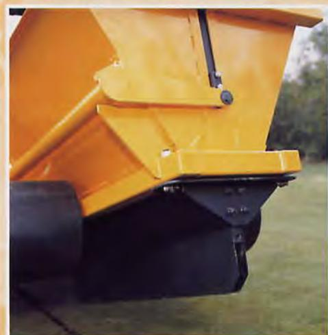
Auf dem Boden des gefrästen Grabens wird eine gleichmäßige Kies-schicht aufgebracht, deren Höhe genau kontrolliert wird. Ein Hydraulisch betriebener Verschuß schneidet den Zufluß des schüttgutes am Ende jeder Fahrt ab, wenn der HOPPER aus dem Graben gehoben wird.
