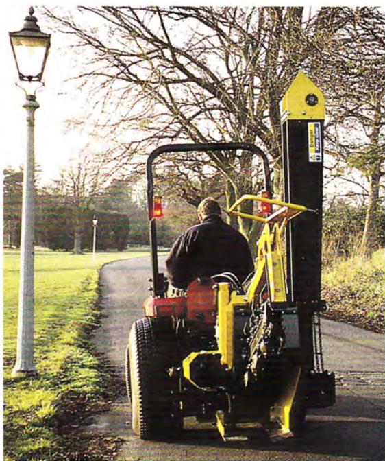
**DIE AFT45 TRAKTOR-ANBAUFRÄSE ist eine leistungsstarke, leightgewichtige Fräse für Kompakttraktoren von 18-37kW (25-50PS).**
