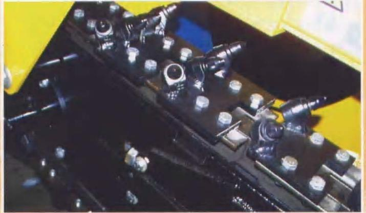
Einfach zu ändernde Grabenbreiten von 125 bis 420 mm und bis zu 1.4 Meter Tiefe.
