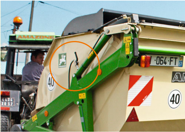
Hydraulische Zylindersperre für Grasshopper-Typen mit Hochkippentleerung
