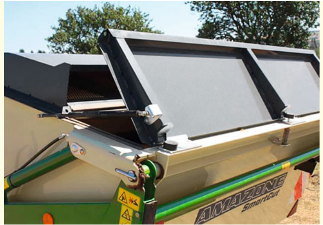
Dämpfer für die Entleerungsklappe
