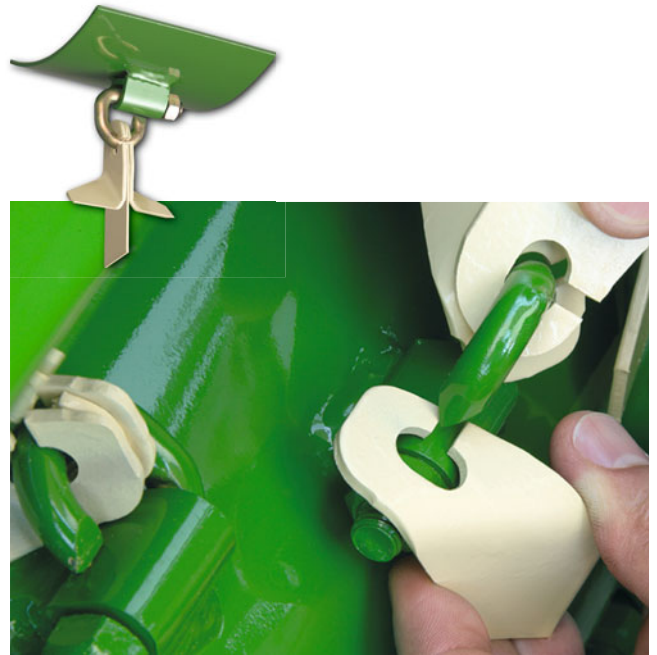
Werkzeugloser Umbau auf Vertikutieren – schnell gemacht
